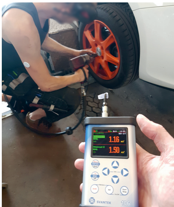
Bild 1. Montering av däck på personbil under mätning av vibrationsnivån. Foto: Jouni Surakka.
